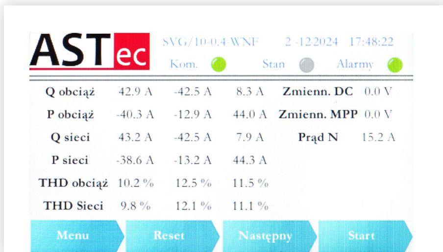
Rys. 4.5. Rys. Ekran przedstawiający brak zgodności faz prąd-napięcie.
